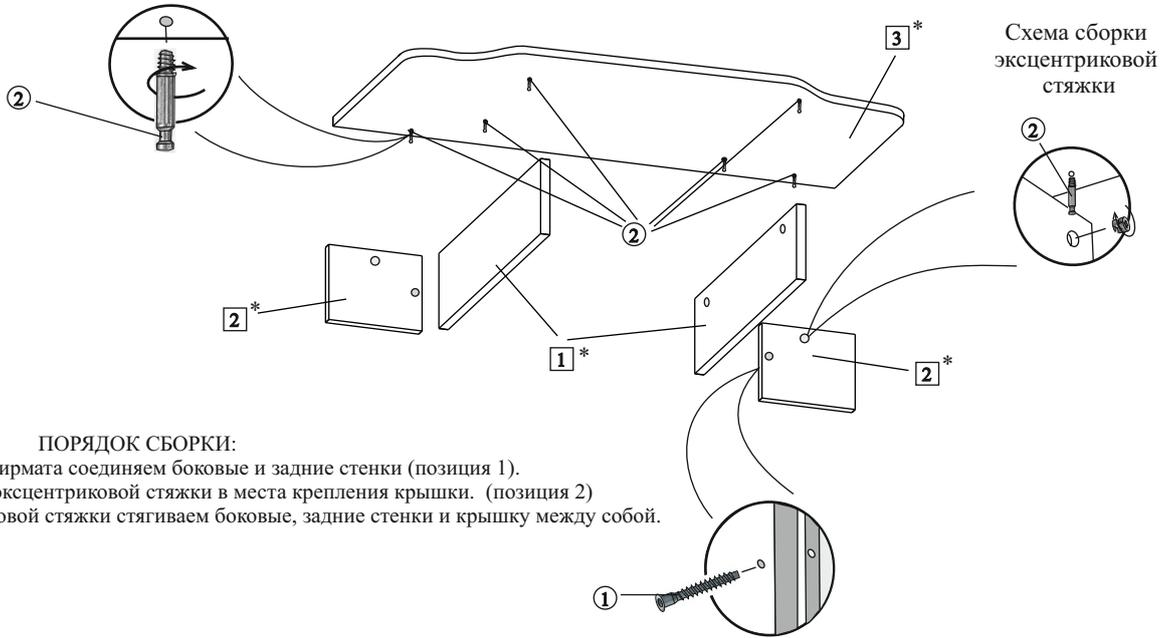
Схема сборки эксцентриковой стяжки
