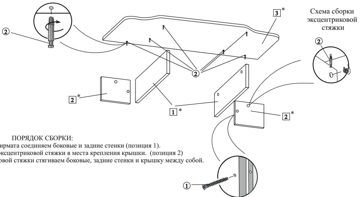
Схема сборки эксцентриковой стяжки
