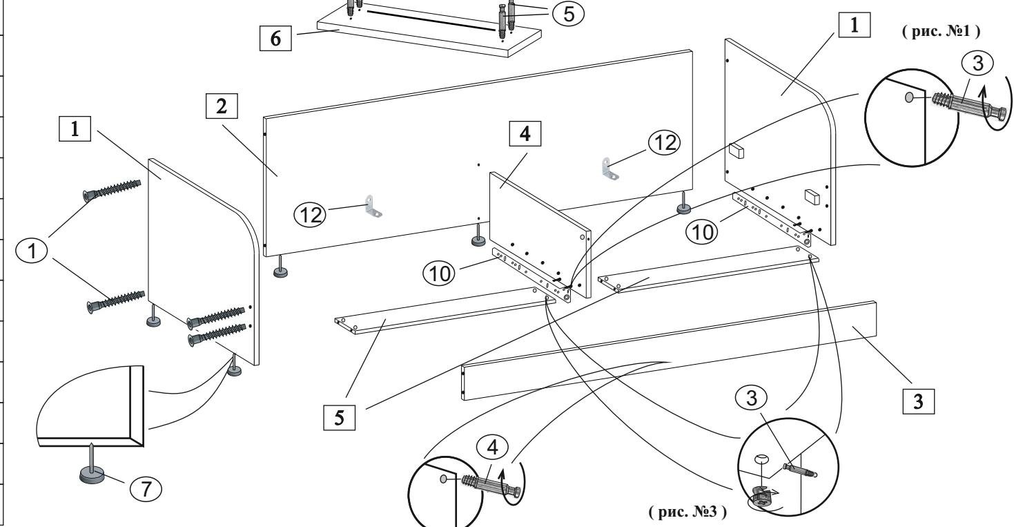
В накладку ящика вворачивается дюбель эксцентриковой стяжки. Ящик складывается согласно схеме, в паз вставляется дно, накладка стягивается с корпусом ящика. **Предварительно просверлив отверстия Ø 2,5 мм,** крепятся направляющие шурупами 4x13. Шурупом 4x16 через фиксатор приворачиваем дно ящика (рис. №5)
